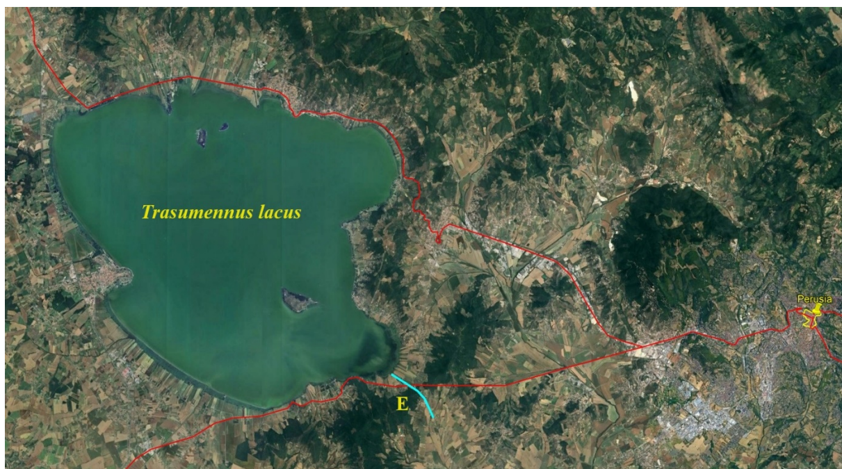
Fig. 2 - L'emissario (E) del lago Trasimeno ( Trasumennus lacus , superficie 128 km 2 ), 256 metri sul livello del mare (mslm), era lungo circa 2450 m e il più grande rilievo che doveva superare era di 316 mslm, quindi con una massima profondità rispetto alla superficie di circa 60 m. Lo scopo dell'emissario era di tenere sotto controllo il livello del lago e di evitare piene dannose. Fu forse costruito dagli Etruschi e poi rinnovato dai Romani, e ricostruito per ordine di Braccio da Montone nel XV secolo 2 . Questa e altre immagini analoghe del presente lavoro sono ottenute da Google Earth con opportune aggiunte, e le lunghezze e i dati altimetrici sono state ricavati mediante Google Earth.
