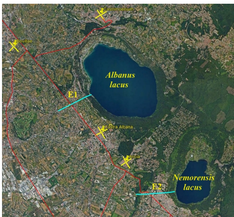
Fig. 4 - L'emissario (E1) del lago Albano ( Albanus lacus , superficie 6 km 2 ), 288 mslm, era lungo circa 1400 m e il massimo rilievo che doveva superare era di 420 mslm, quindi con una massima profondità rispetto alla superficie di circa 132 m. L'emissario (E2) del lago di Nemi ( Nemorensis lacus , superficie 1,67 km 2 ), 320 mslm, forse realizzato nel IV sec. a.C. dai Latini di Aricia, era lungo circa 1500 m e si continuava con un canale. Il massimo rilievo che doveva superare era di 450 mslm, quindi con una massima profondità rispetto alla superficie di circa 130 m. Per entrambi i laghi lo scopo degli emissari era di tenere sotto controllo il livello del lago e di evitare piene dannose.
