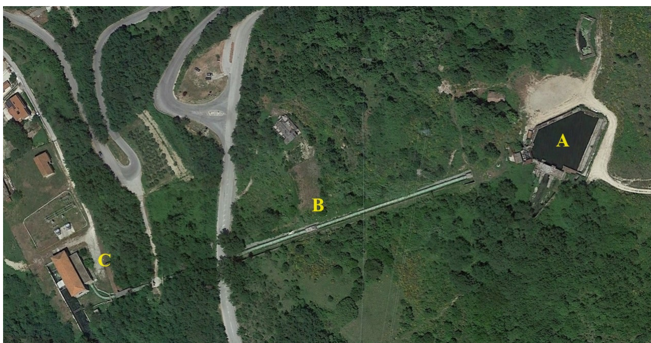
Fig. 26 - Sbocco del secondo emissario del Fucino. A: vasca di raccolta delle acque; B: Condotta forzata; C: centrale idroelettrica ENEL.
